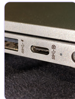
Un puerto USB-C: los contactos y la lengüeta se desgastan con el uso. Foto: Logant547 · CC BY 4.0 · Wikimedia Commons
