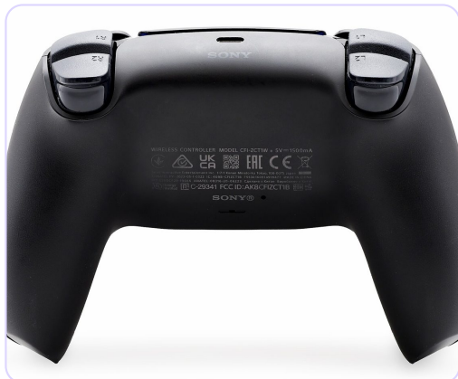
Parte trasera del DualSense: el orificio de reset está junto al gatillo L2. Imagen de referencia.
