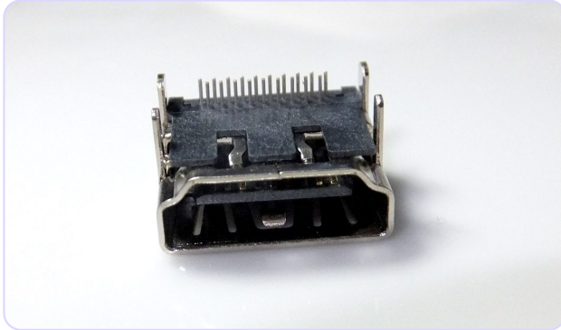
Un conector HDMI hembra de placa. Se sujeta por soldadura: los tirones levantan pistas y pads. Imagen de referencia. Foto: Jdbcomputing · CC BY-SA 4.0 · Wikimedia Commons
