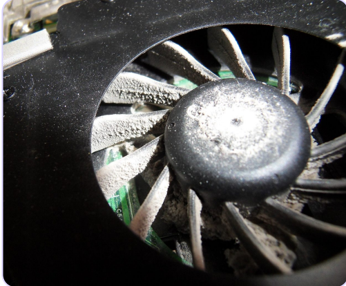
Ventilador con polvo y suciedad pegada a las aspas (referencia genérica).
