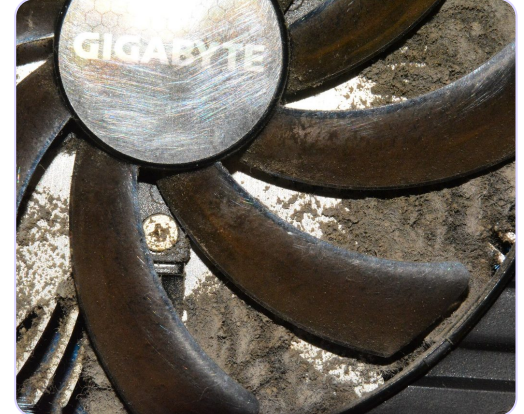
Polvo acumulado en un ventilador y disipador (referencia genérica).
